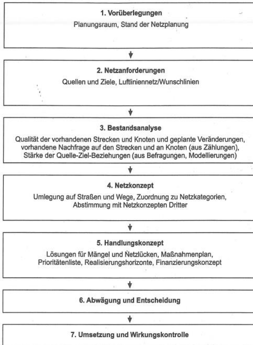
Bild 2: Ablauf einer Radverkehrsnetzplanung für den zielorientierten Alltagsradverkehr
