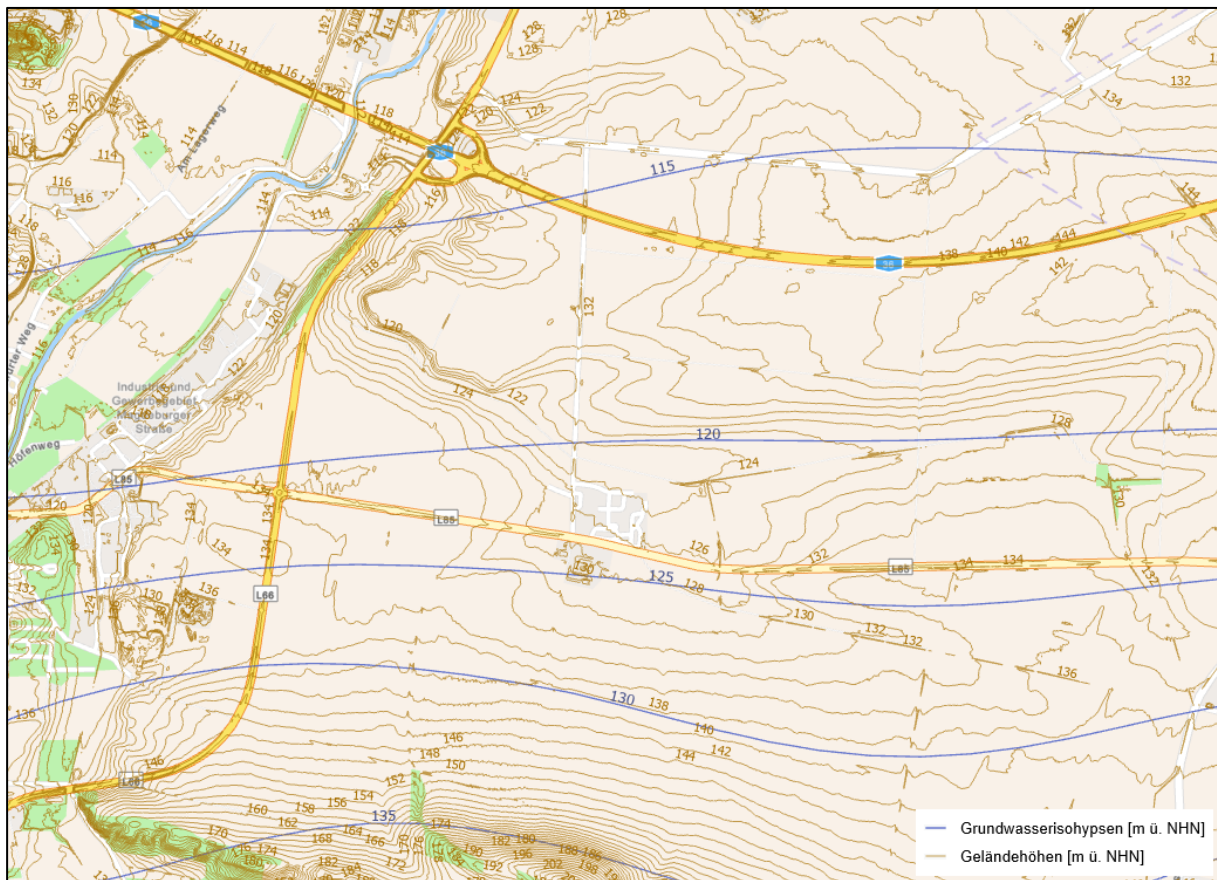
Abbildung 3: Grundwasserisohypsen und Geländehöhen /30/
