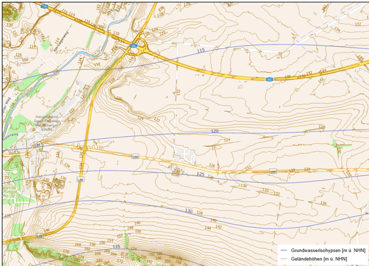
Abbildung 3: Grundwasserisohypsen und Geländehöhen /29/
