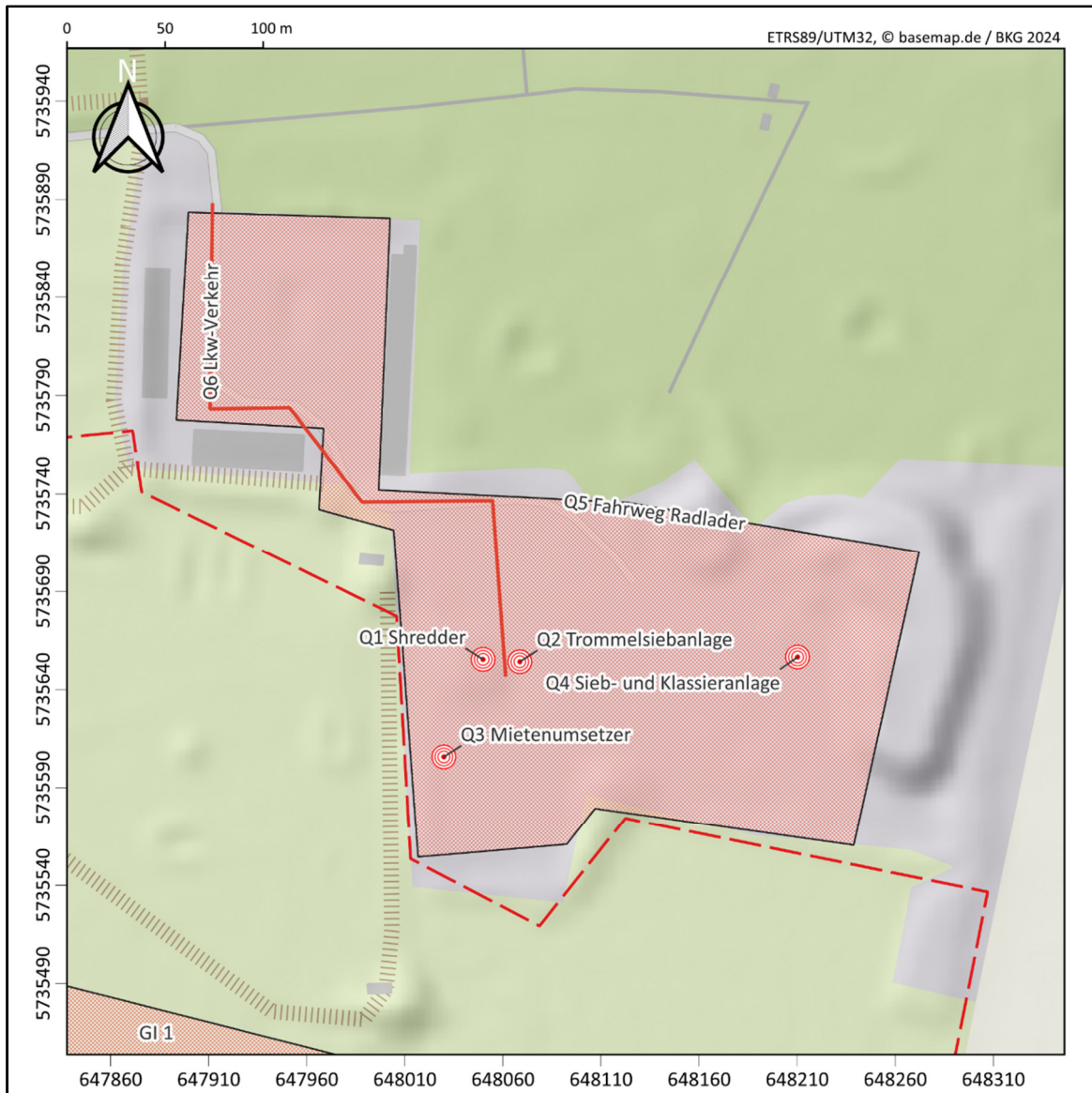
Abbildung 4: Lageplan Schallemissionsquellen Vorbelastung Kompostieranlage
