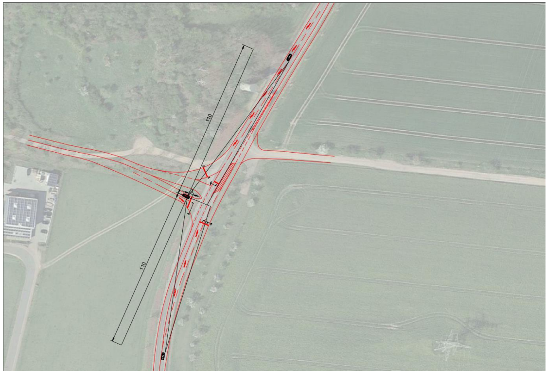
Abbildung 14: Anbindung L242 Variante lichtsignalisierte Einmündung mit Sichtdreiecken (Quelle Hintergrund: Google Earth Pro)
