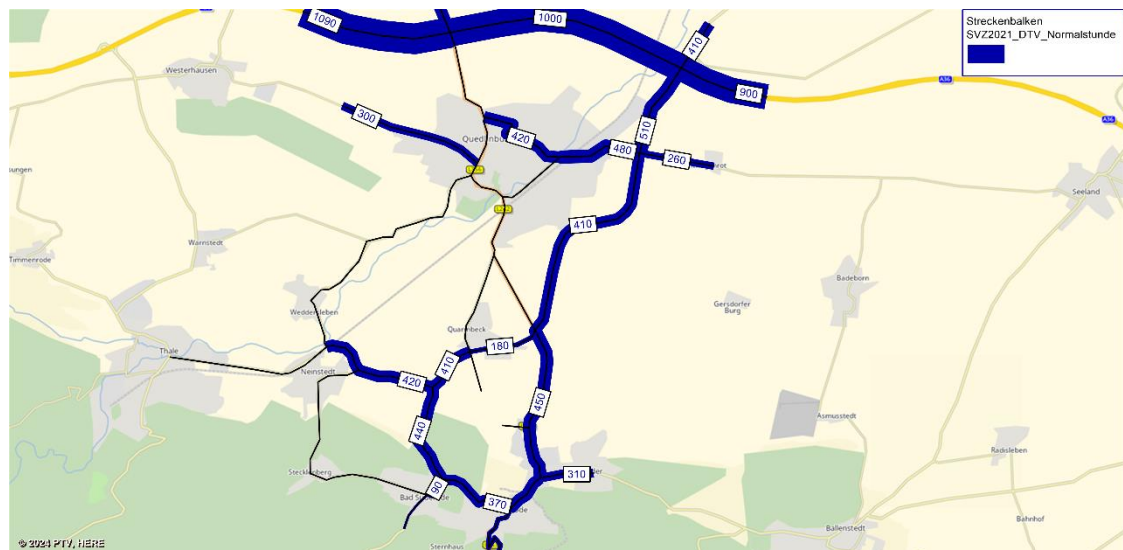
Abbildung 4: Querschnittsbelastung DTV Kfz Normalstunde (6% der 24h Belastung) (Quelle Hintergrund: PTV, HERE)
